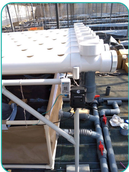
水槽での設置例 センサー部を水槽に入れて水温を計測
