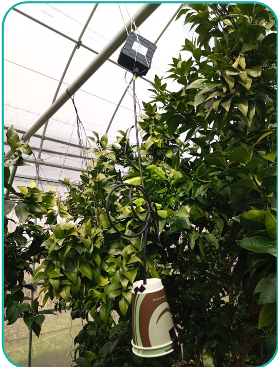
かんきつハウスでの設置例 日光の影響でセンサー部が温まらないように遮光と断熱効果のある素材でカバー
